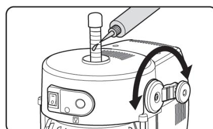
**5** 上カバーを取り付け、上下ハンドル軸に上下ハンドルを取り付けます。主軸を上下させながら主軸に給油してください。給油後、シャフトカバーを取付けてください。(P.7シャフトカバー取付参考)
