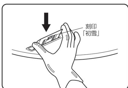
7 新しい刃物の刻印「初雪」がガイドプレート側になるようにして、円盤の上からブレードホルダーとガイドプレートの間に差込んでください。
