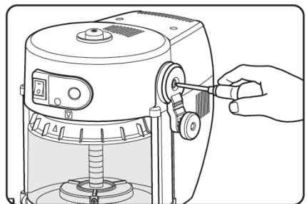
**3** 付属の取り付けネジを上下ハンドルに通して⊕ドライバーで締付け、上下ハンドルを回して主軸が上下することを確認してください。
