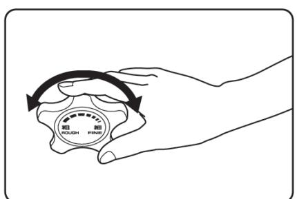
9 刃物調節ツマミを左右に回して、お好みの粗さに調節してください。
