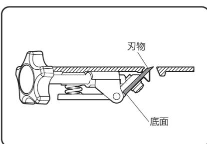
8 刃物の底面をブレードホルダーに当て刃物固定ネジで固定します。
