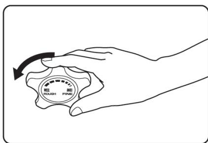
4 刃物調節ツマミを左に回して刃先が円盤の平らな面より出るようにしてください。
