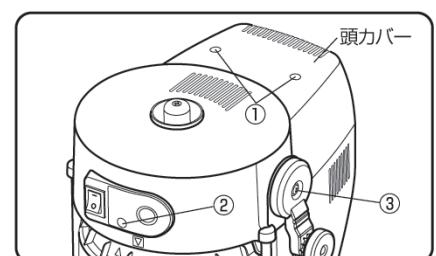
**3** 上カバーを取り付けている小ネジ①②を⊕ドライバーで取り外してください。②は丸いラベルをはがしてネジを外します。上下ハンドルを取り付けているネジ③を⊕ドライバーで取り外してください。
