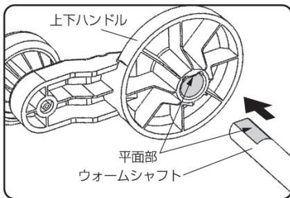
**2** 軸の平面部と上下ハンドルの平面部を合わせて挿入してください。
