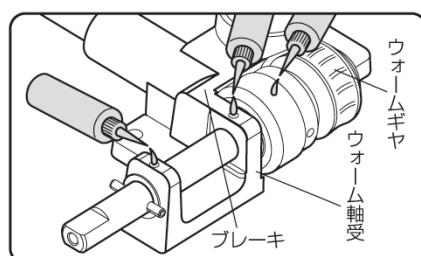
**4** 上下ハンドルをウォームシャフトに一時差し込み(P.7上下ハンドル取付参照)、上下ハンドルを回しながら、ウォーム軸受の上部小穴2ヶ所と、ブレーキとウォームギヤーの接触面に充分給油してください。
