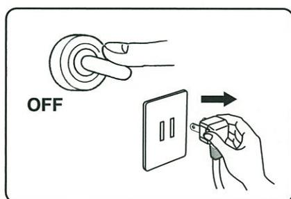
**1** 電源スイッチをOFF(切)にして、コンセントから電源プラグを抜く。
