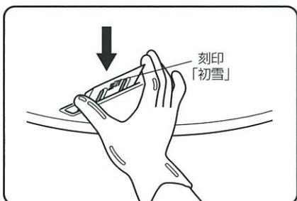
**7** 新しい刃物の刻印「初雪」が刃物押え側になるようにして、円盤の上から刃物受と刃物押えの間に差込んでください。
