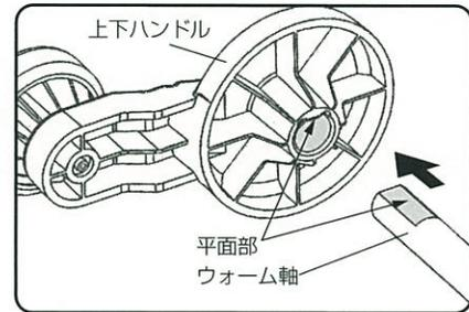
軸の平面部と上下ハンドルの平面部を合わせて挿入してください。
