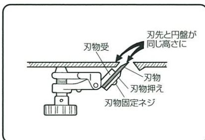
**8** 刃先が円盤上面と同じ高さで、平行になるようにして刃物固定ネジで固定してください。
