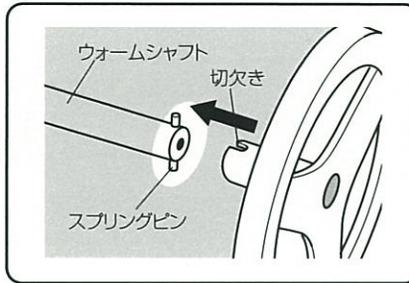
**2** ウォームシャフトのスプリングピンが上下ハンドルの切欠きに入るように入れてください。
