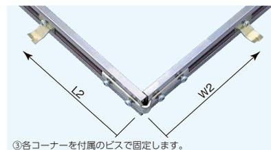
③各コーナーを付属のビスで固定します。必ずW2・L2寸法を確認した上で組立・固定してください。コーナー金具固定後、外枠を平坦な所に置いて変形・歪みがないかご確認ください。
