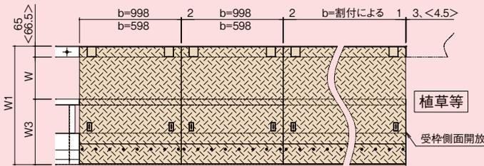
※ < >寸法は、受枠-鋼製の場合を示します。
