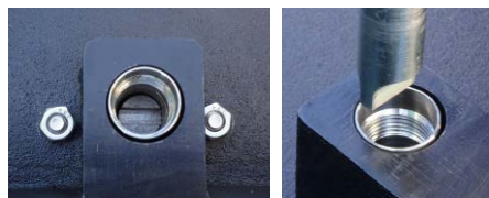
①キャップをハンドルを使用し外したらハンドルのマイナス部を差込む。
