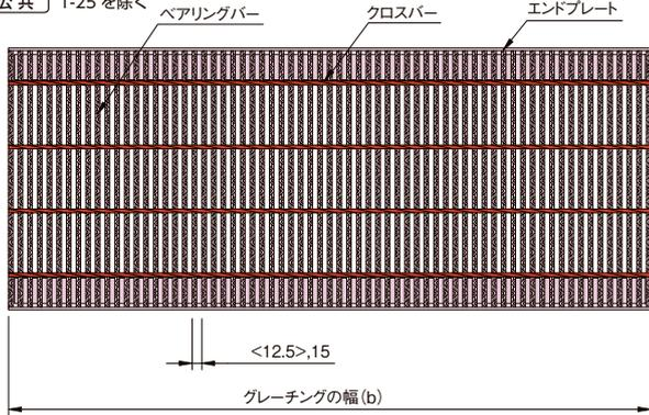
注、<math>\langle \rangle</math>寸法は 型式記号 CXHK3\*\*タイプ (ベアリングバー厚み3mm) の場合を示す。
