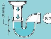
本体に50mmの封水がもうけられたシンプルな構造。調節管と排水管の接合部が同一のねじです。
