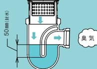
調節管ねじは排水管ねじより大きくなっています。ゴミ取り用のバスケットが付属します。
