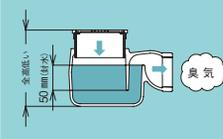
調節管ねじは排水管ねじより大きくなっています。トラップの全高が低くなっており、高さが取れない現場に適しています。
