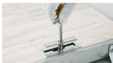
② 専用ハンドルを反時計回りにネジが緩むまで回します。最後まで回すと取手がバネで浮上します。
