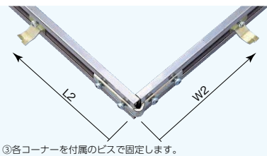
③各コーナーを付属のビスで固定します。必ずW2・L2寸法を確認した上で組立・固定してください。コーナー金具固定後、外枠を平坦な所に置いて変形・歪みがないかご確認ください。
