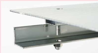
①固定側受枠のナット部に六角穴付ボルトを嵌合させます。
