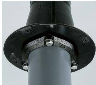
⑫スラブ打設後 防水継手本体とフランジセットを六角ボルトにて固定してください。
