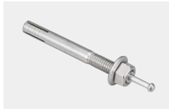
③オールアンカーに皿バネ付ナットをねじ込んでください。ボルトの頭が少し出る程度にして、②で開けた下穴に差し込んでください。
