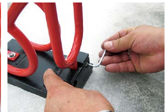
⑧専用レンチを使用してベースにベースカバーを取り付けて完成。
