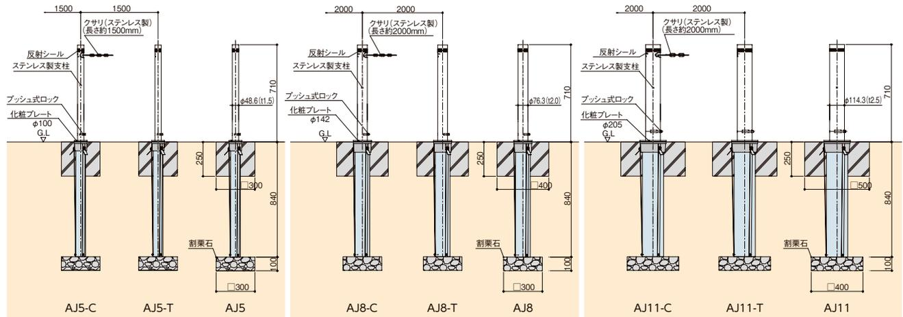
▲ポール収納部の底部は割栗石で押し固められた状態にしてください。
