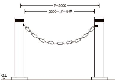
ポールピッチが 2m の場合、チェーン自体の長さは 2m となり、実質的には、ポール径分がチェーンのたわみとなります。
