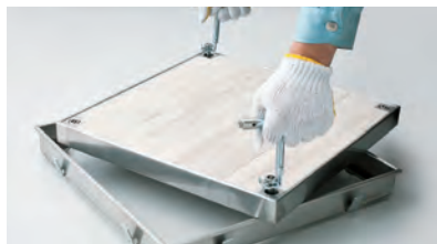
②専用鍵ハンドルのフック部を対角2箇所の錠ボルトに引掛けてハッチを持ち上げます。
