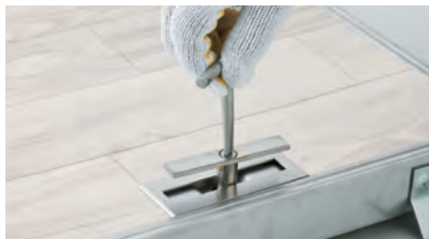
②専用ハンドルを反時計回りにネジが緩むまで回します。最後 まで回すと取手がバネで浮上します。
