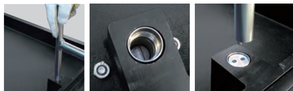
②ハンドルを下に押しながら時計回りに回転する。回らなくなったらハンドルを上げる。閉錠状態です。キャップを取付け施錠完了。
