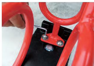
⑤専用レンチでベースに本体を取り付ける。
