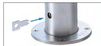
プッシュ式ロック 専用キーを鍵穴に差し込み プッシュして右に 90° 回転 すると施錠が行えます。
