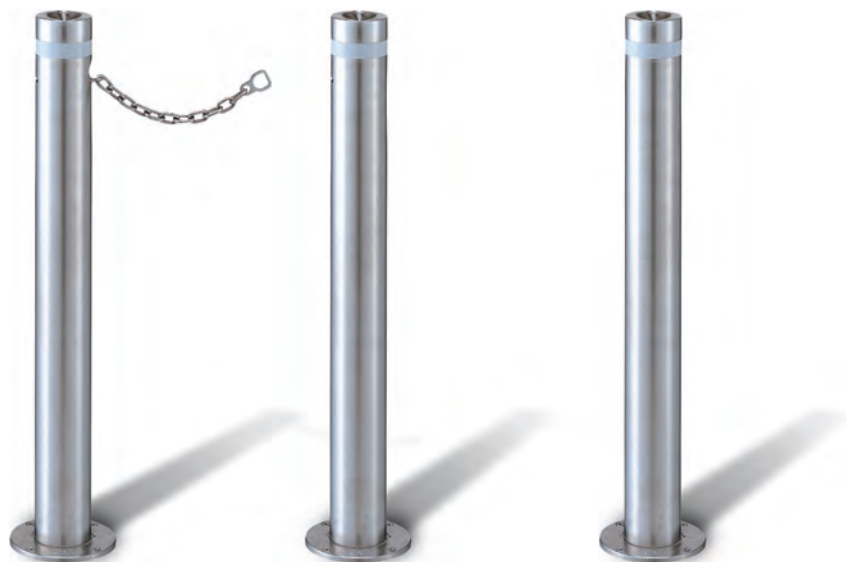
チェーンロック 先端リングを引っ張りクサリを引き出します。隣接するポールに挿入し、専用キーで簡単にロックすることができます。
