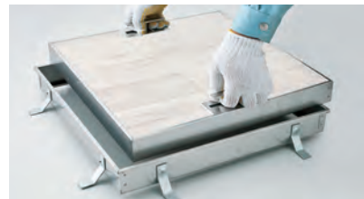
③取手を持って開閉します。閉める時はネジロック部を時計回りに取手が納まるまで回して固定します。
