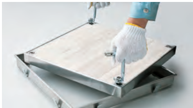
②専用鍵ハンドルのフック部を対角2箇所を鋭ボルトに引掛けてハッチを持ち上げます。
