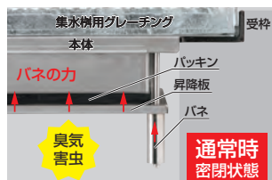
バネが昇降板を押し上げ、パッキンが密着! 臭いや虫をブロック。 通常時 密閉状態
