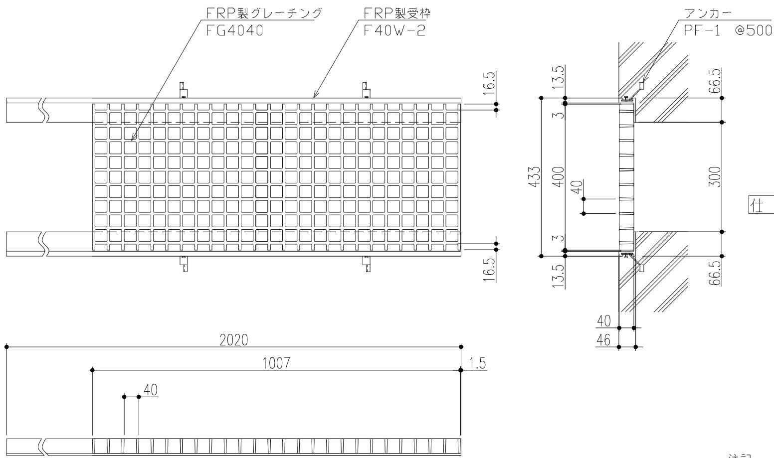
特記事項。。。指示なき製作基準は製品規格による。
