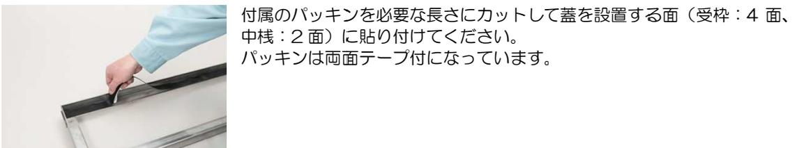
付属のパッキンを必要な長さにカットして蓋を設置する面（受枠：4 面、中棧：2 面）に貼り付けてください。
