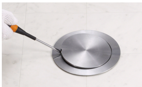
⑦ ふたを取り外す時はふたの切り欠き部に、マイナスドライバーを差し込み外してください。
