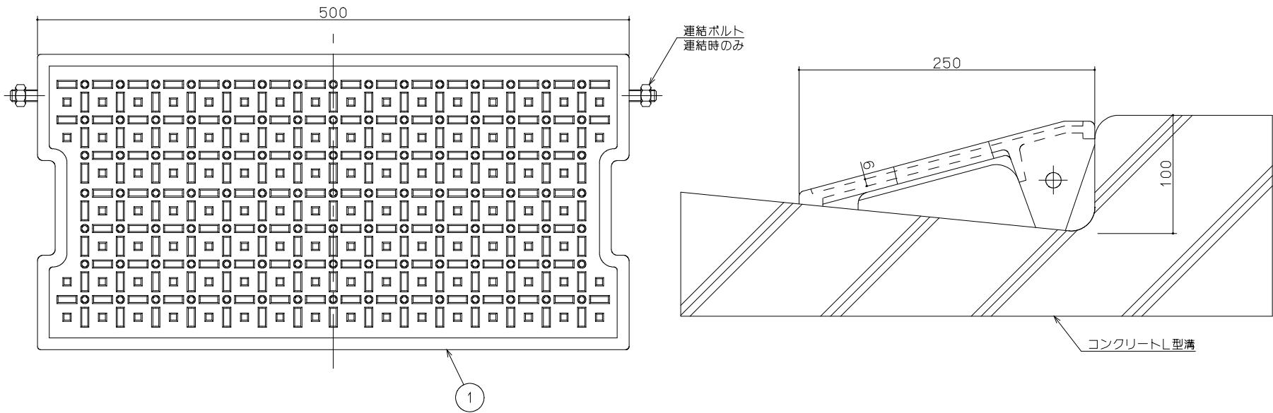
\* J I S A 5306 コンクリートL型溝にマッチします。(250A・B共通に使用できます)
