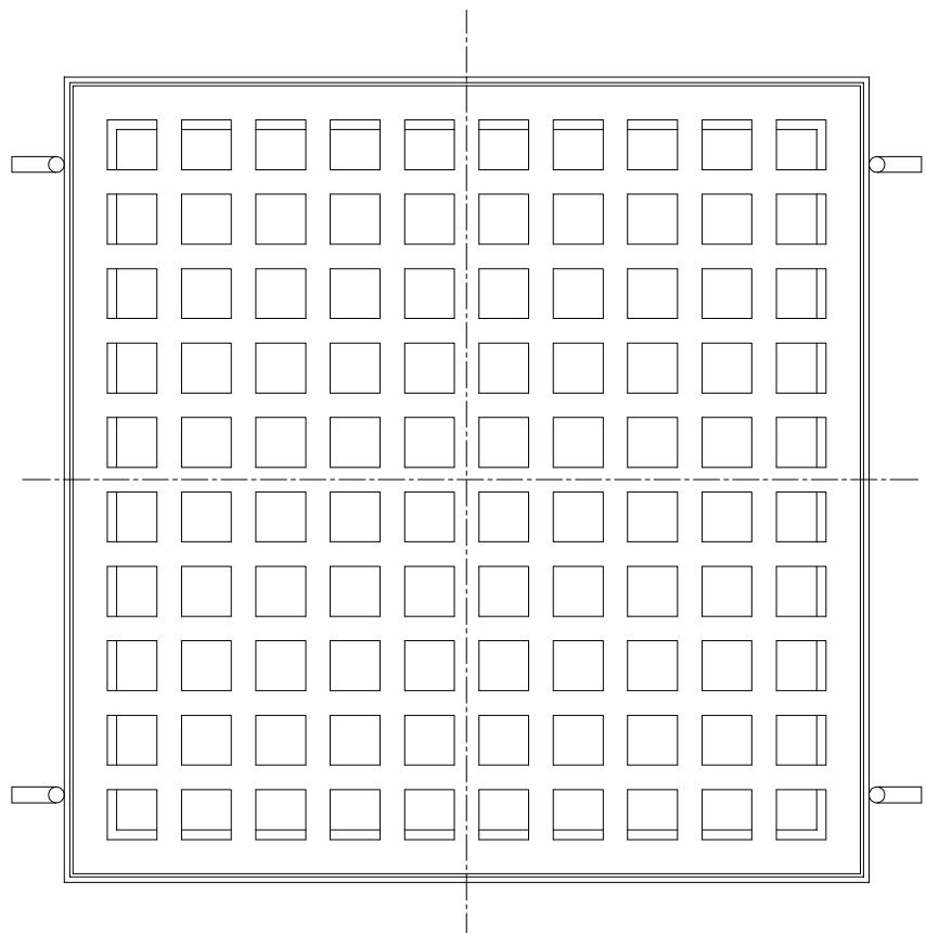
枠の上面と床の仕上げ面は、同じ高さになるように施工して下さい。
